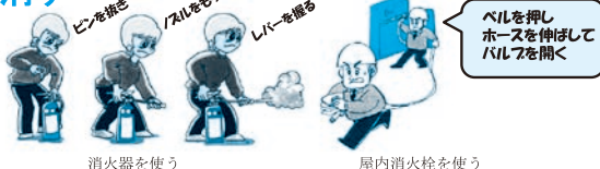
消火器を使う 屋内消火栓を使う
