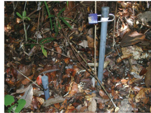
データロガーによる地下水位の現地観測
