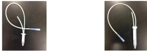
シリコンチューブ、エッペンチューブまたは遠沈管を半田ごてまたは穴あけドリルにより安価で容易に作成
