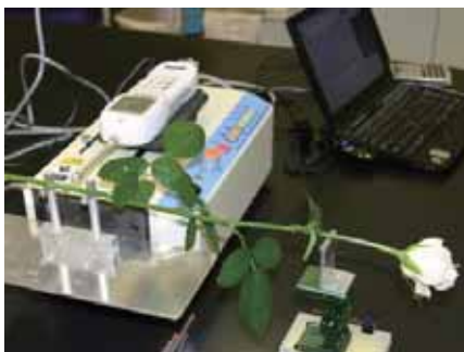
バラ切り花の茎の曲げ試験の様子
