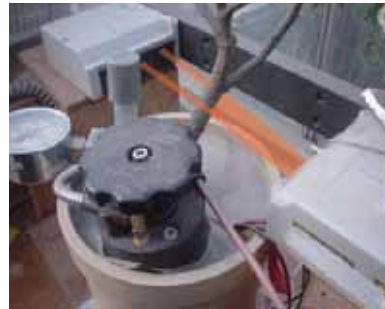
レーザー光による茎径計測
