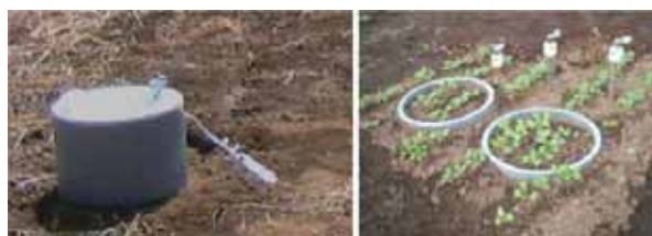
GHGs 発生量測定用のチャンバと土中ガス採取管
