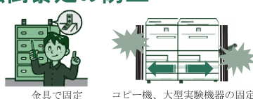
金具で固定 コピー機、大型実験機器の固定
