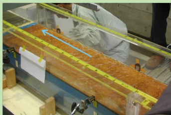
水路侵食試験の例
