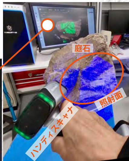
庭石の 3D スキャンの様子 右: ハンディスキャナーで石に LED を書写して計測中 左: 計測時のパソコン画面 (緑部分が照射面、カラーは計測済み)
