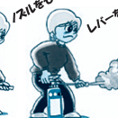
ピンを抜き ノズルをもって レバーを握る
