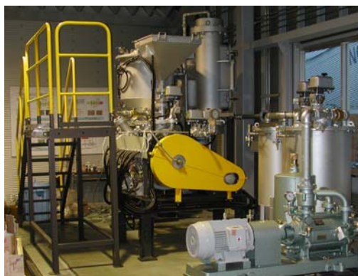
バイオマスエネルギーセンター内の エタノール固体発酵装置
