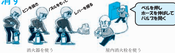
消火器を使う 屋内消火栓を使う
