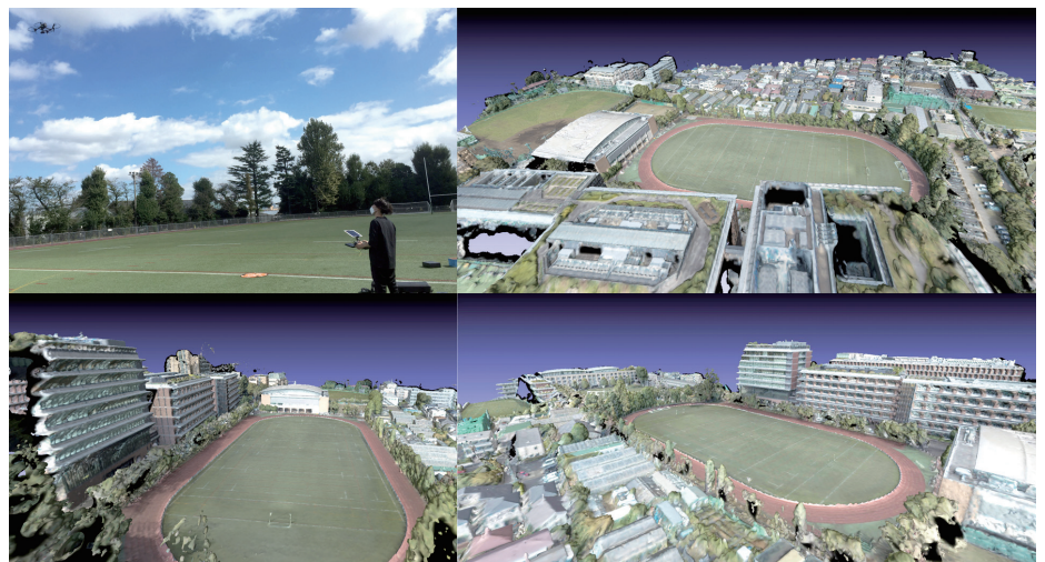
図1 UAV 写真測量による世田谷キャンパスの3Dモデリング
