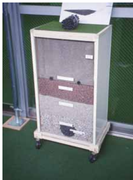
世界一の芝生ピッチを支える植栽基盤 30cmの砂の下に50～60cmの3層の砂利の排水層。豪雨時でも湛水せずプレーが可能
