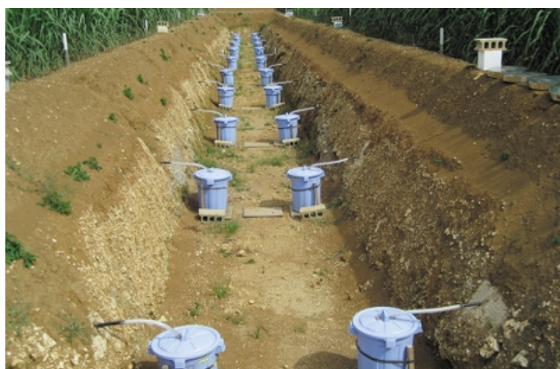
サトウキビ圃場からの浸透液を採取するタンクの様子
