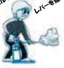
ピンを抜き ノズルをもって レバーを握る
