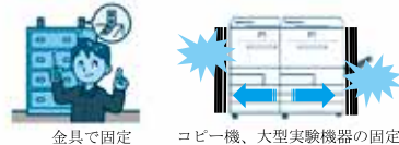
金具で固定 コピー機、大型実験機器の固定
