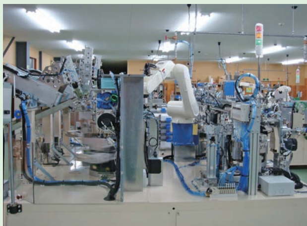
図 自社開発した自動巻き線機を用いて国内24時間体制で生産
