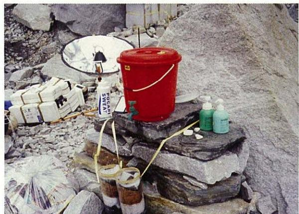
写真10 洗面など少量の生活排水の処理
