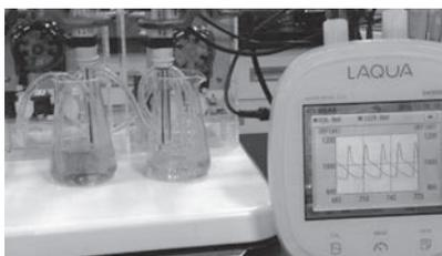
BZ 反応による結合振動子系の実験
