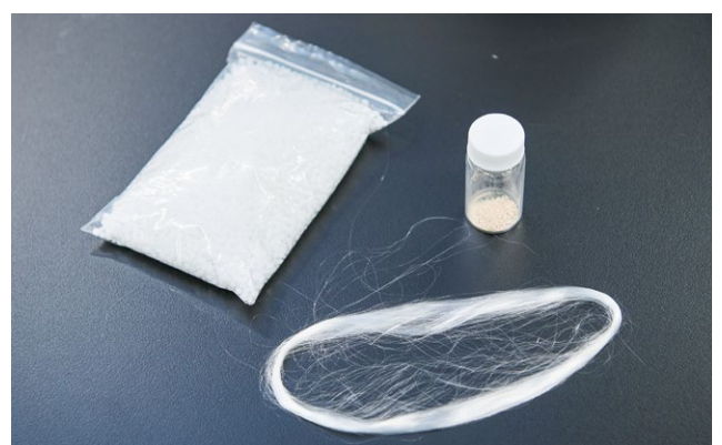
図1 バイオプラスチック(ポリ乳酸)ペレット(上左)および粉末(上右)と実験室で作製したポリ乳酸繊維(下)
