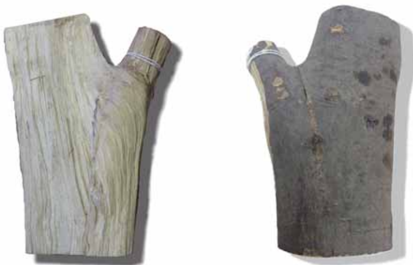
秋に採取した幹枝材 広義のブランチカラーとトランクカラーの繊維の流れ
