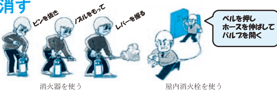
消火器を使う 屋内消火栓を使う
