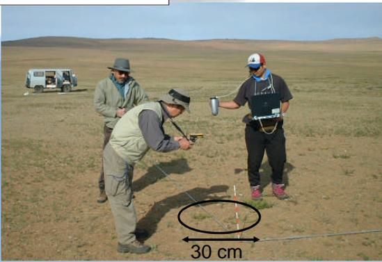
分光放射計を用いて地表面の分光反射率(光の波長毎における反射率)を計測すると、地表面の違いによって様々なパターンを示す(右図)。衛星画像データ(LANDSAT, MODIS, ALOS, IKONOS, QuickBird)はこの中のB1)青色波長帯、B2)緑色波長帯、B3)赤色波長帯、B4)近赤外線波長帯における反射率を広域に計測したものである。
