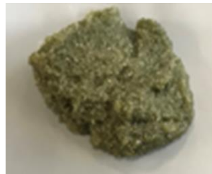
写真 6 浸透防水モルタル
