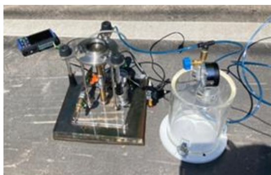
写真 10 現場透気試験
