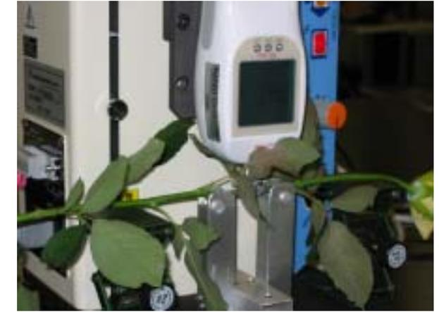
流通中の品質変化の評価を行う方法として、切り花の切り前の影響を受けにくい茎に着目することにより、花卉がまだ開いていない収穫直後から測定が可能であり、収穫直後の最も鮮度の高い状態を基準として鮮度低下をもとに品質の変化を評価することが可能となります。茎の硬さを評価するために図2に示すように、圧縮試験機を用いて曲げ弾性係数の測定を行います。ガーベラ切り花の水揚げ後の茎がしおれから回復する過程での測定結果を図3に示します。時間の経過とともに曲げ弾性係数の値が大きくなっていることがわかります。すなわち、水揚げをすることによりしおれていた茎が次第に硬くなりしおれが回復していることがわかります。
