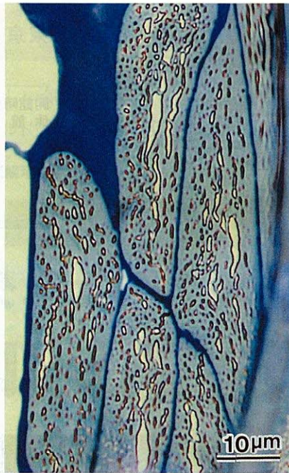
アゲマ繭糸折片の光学顕微鏡写真
