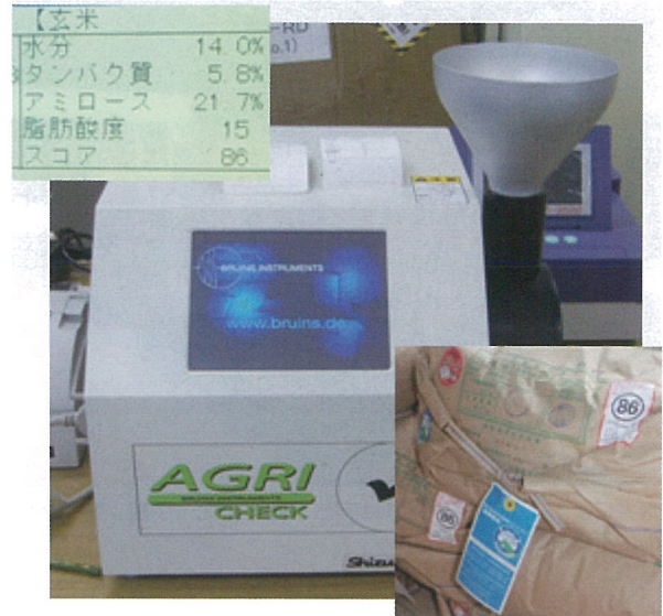
「食味計」でお米のおいしさを測り、「食味値」シールを貼って出荷
